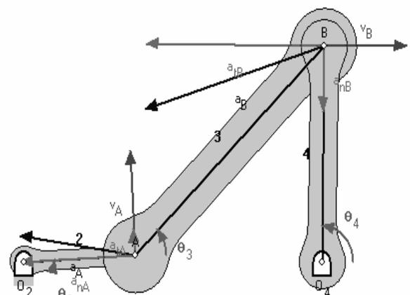
Figura 6. Velocidades y Aceleraciones del mecanismo Manivela-Biela-Balancín.
