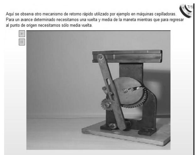
Figura 11. Máquinas Reales. Mecanismo Retorno rápido.
